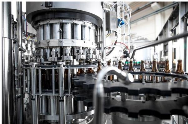
A tampadora ultralimpa de tampas coroa fabricada pela Sidel, com seu design aberto e anel aplicador descentrado, assegura ainda mais desempenho ao envase, dispensando lubrificação interna.
